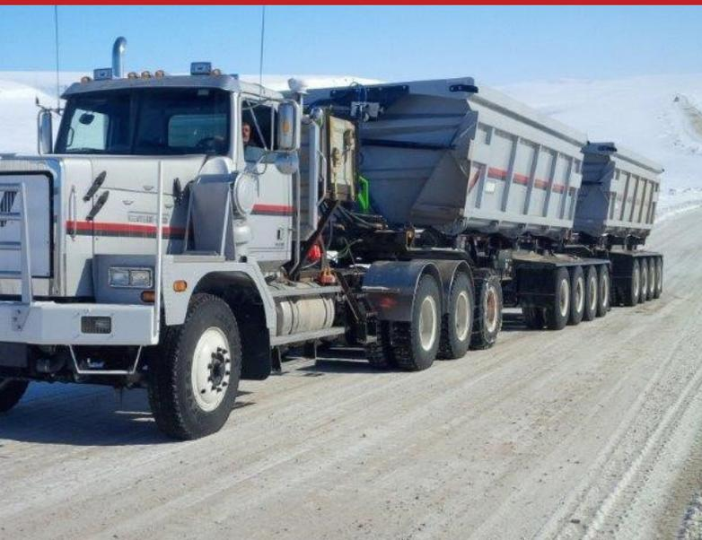
L'essieu KGI hors route est conçu pour une résistance et une fiabilité maximale, supportant des charges de 50 000 à 65 000 lb par essieu. Avec des options personnalisables pour convenir à un large éventail d'industries, c'est la solution parfaite pour les remorques à usage intensif qui exigent performance et polyvalence.
