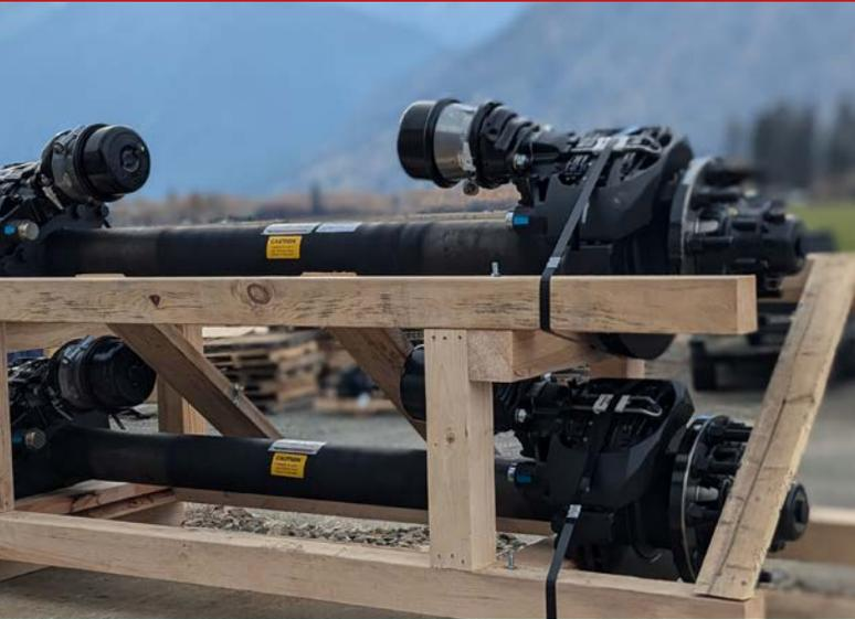
L'essieu de remorque standard KGI a été conçu et fabriqué avec soin en utilisant des produits de la plus haute qualité pour une performance et une longévité maximale. Avec des caractéristiques telles qu'une poutre intégrale d'une seule pièce et des tubes d'essieu à paroi de  $\frac{3}{4}$ "", il est garanti qu'il répondra à vos divers besoins.
